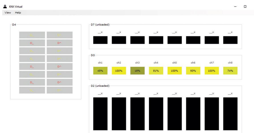
Základní náhled s 8 stmívanými obvody, se kterými lze komunikovat
